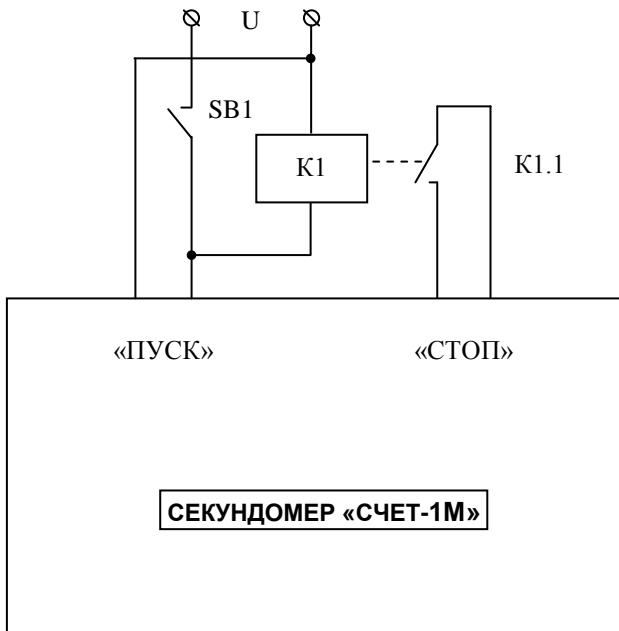
При замыкании переключателя SB1 происходит срабатывание реле K1. Напряжение U прикладывается к входу «ПУСК» секундомера и начинается отсчет времени. После замыкания контактов K1.1 счет прекращается.
