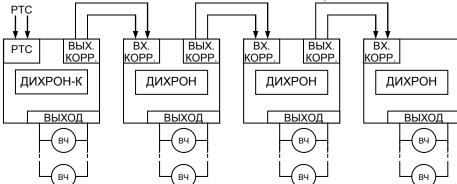
Суммарное сопротивление 2-х проводов между контактами «ВЫХ.КОРР.» предыдущих первичных часов и контактами «ВХ.КОРР.» последующих должно быть не более 150 Ом (800 м провода сечением 0,2 мм²).
