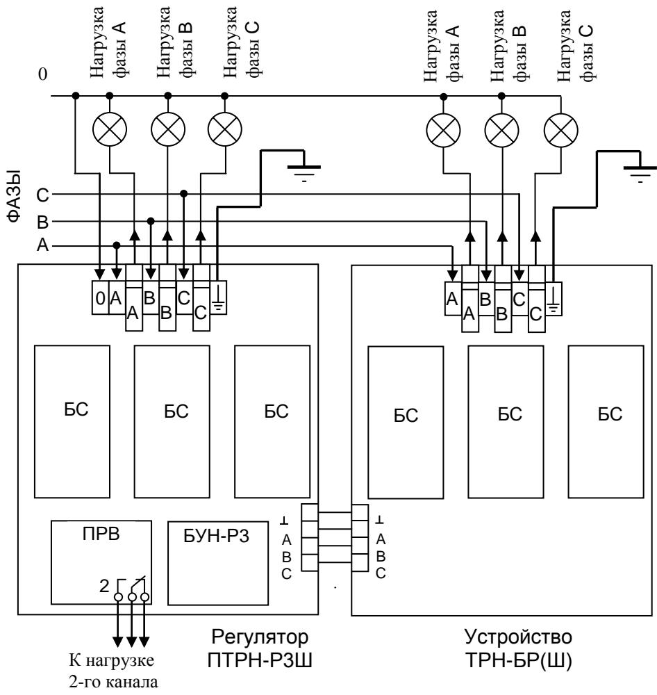
4.4. Автоматические выключатели на регуляторе и устройстве ТРН-БР(Ш) установите в отключенное положение.
